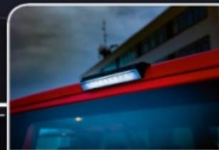
Die Umfeldbeleuchtung in LED-Ausführung sorgt für ausreichend Helligkeit in der näheren Umgebung des Fahrzeuges. Betrieben wird die Umfeldbeleuchtung mit der Bordspannung des Fahrzeuges.
