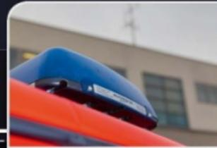
Ein flacher und kostengünstiger Blaulichtbalken der Type „Eurosignal Xpress“ mit entsprechender Signaleinrichtung sowie einem Modul für die Kennzeichnung als Einsatzleitung wurde fix am Dach verbaut.
