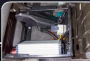
Ein Spannungswandler transformiert die 12 Volt Fahrzeugelektrik auf 230 Volt Wechselspannung, die unter anderem für die Versorgung der Ladestationen benötigt wird.
